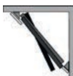
Figur 4: Eksempel på skråabsorbent
